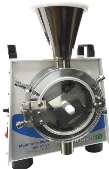
Figura 10: Moinho de facas tipo Willye utilizado para triturar as farinhas. Fonte: Fortinox (2019).
